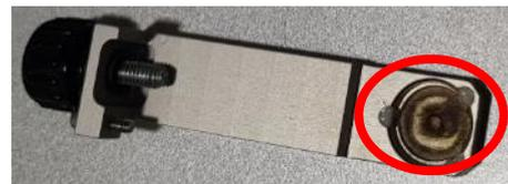
*Ejemplo de blast shield dañado*
