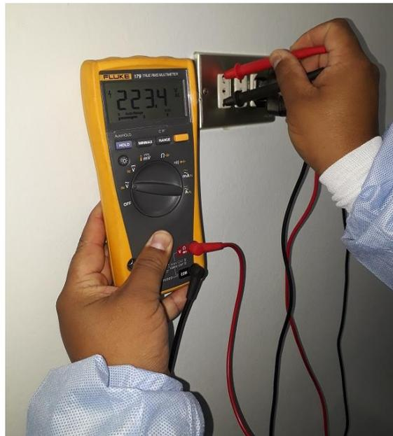
Medicion de Voltaje en enchufe de 16 amp. del circuito hubicado detrás de maquina anestesia, con equipo conectado marca 218V
