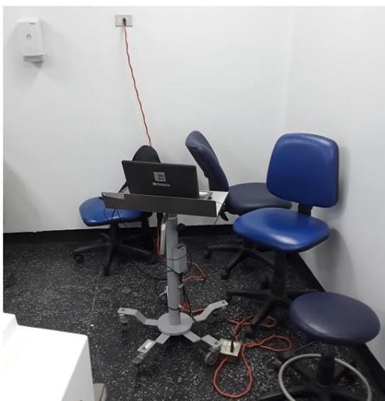
Medicion de Voltaje en enchufe de 10 amp. del circuito hubicado bajo meson de trabajo, Con equipo conectado entrega 218V, Al momento de encender el equipo, baja el voltaje hasta los 208V.
