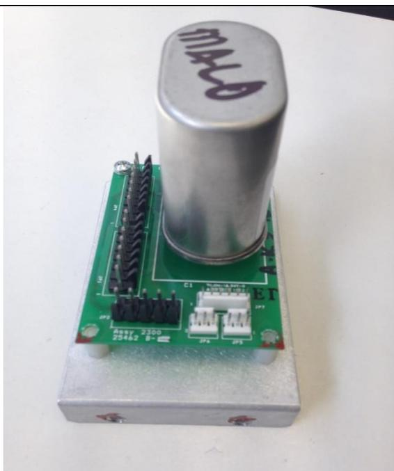
Tarjeta Capacitor Ventiladores Quemada por sobrecarga.
