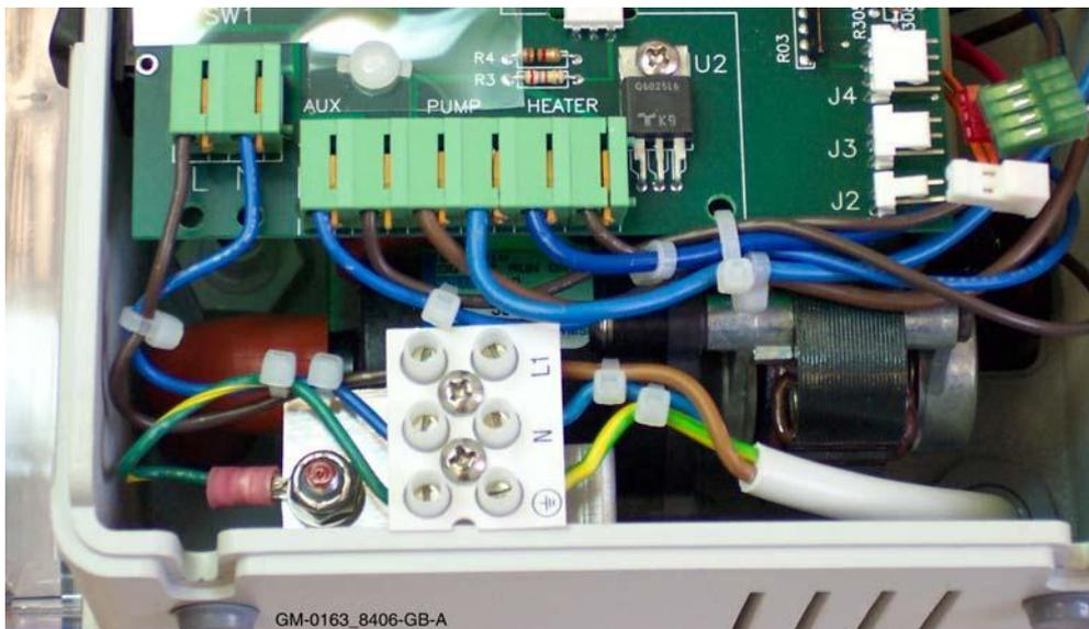
Alternativamente, las pestañas se pueden manipular con una pequeña destornillador recto a través de la ranura en la superficie superior de la terminal.
