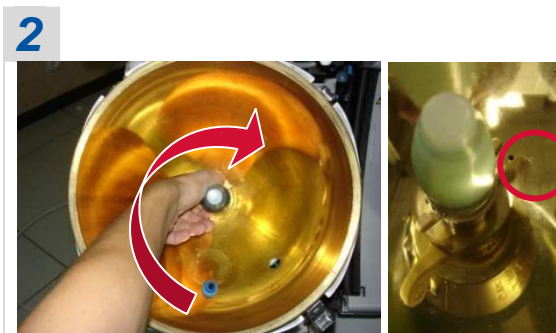
Insérer l'électrode (contrôler la position de l'index)
