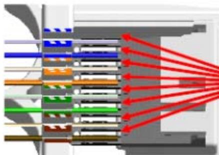
Disposición de cables para el montaje del conector
