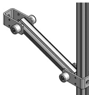
DETALLE ESTABILIZADOR DE ANCLAJE A LOSA
