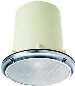
Altavoz de techo para montaje empotrado, con membrana de alta densidad molecular y recinto posterior sellado para ambientes libres de partículas, como laboratorios, salas informáticas o salas blancas. Tiene una potencia de 5 W RMS sobre línea de 100 V, respuesta en frecuencia de 150 a 20.000 Hz, sensibilidad (1 W, 1 m, 1 kHz) de 87 dB y una presión acústica máxima de 94 dB (5 W, 1 m, 1 kHz). Altavoz de 8 cm.
