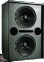
El 650-P es un subwoofer autoamplificado, entonado, de tipo bass-reflex, que utiliza dos parlantes de cono de 18 pulgadas de gran capacidad de excursión y mínima distorsión. La unidad extiende el rango de baja frecuencia de los sistemas de altavoces Meyer Sound, proporcionando una respuesta de frecuencia de 28 a 120 Hz.
