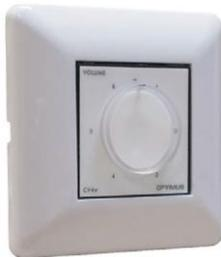
Las atenuadoras CV regulan la entrega de potencia con un conmutador rotatorio, con 6 posiciones de atenuación y otras 6 de enmudecimiento de la señal. Disponen de función de seguridad de avisos, y los modelos de 12, 40 y 60 W disponen de transformador, adecuados para sistemas con supervisión de líneas de altavoces.
