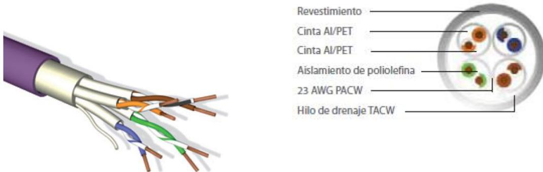
Cable de comunicación, F/FTP, 100  $\Omega$ , 4x2xAWG 23/1. Es un cable de cubierta de alta calidad de Clase EA / Categoría 6 aumentada para admitir protocolo de Ethernet de 10 Gigabits para instalar en zonas horizontales y en troncales de area.
