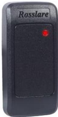
La lectora con un formato de salida Wiegand 26 bits lee tarjetas EM RFID tipo ASK de 125KHz desde una distancia de hasta 80 mm (3,15 in.).
